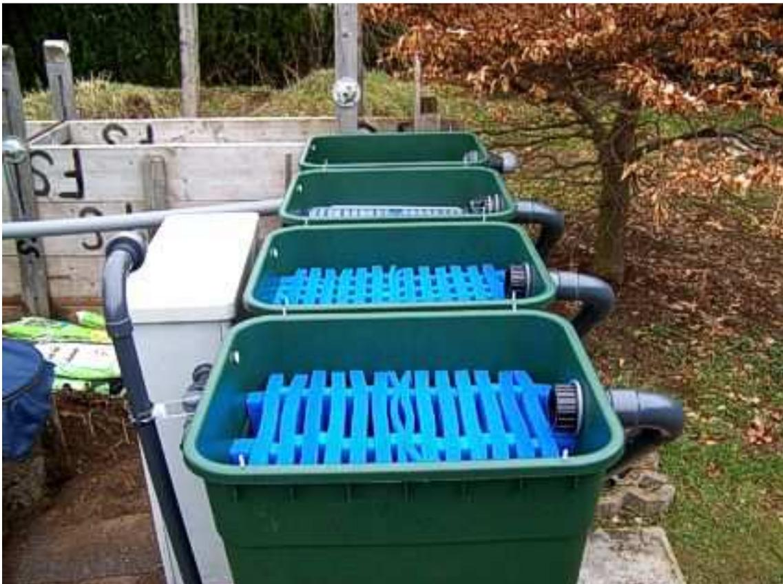
In der zweiten Tonne etwas feinere Filtermatten, in der dritten Tonne Filtermattenschnipsel und diese mit einem Lochbrett aus Plexiglas abgedeckt, damit diese nicht in die letzte Tonne fließen und alles am Ende verstopfen können.
