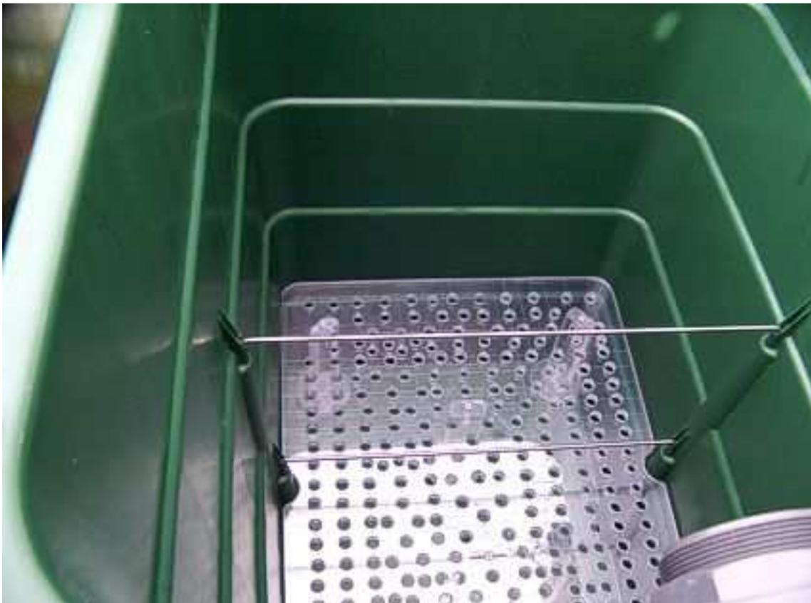
Dieser Boden dient als Auflage für die Filtermedien, und soll den Schlamm von den Filtermedien trennen. Der Schlamm kann dann bei Bedarf während der Filter in Betrieb ist, auch mal durch die Auslaufhähne abgelassen werden. Der Wasserzulauf in der ersten Tonne wird unten eingebaut, damit das Teichwasser langsam von Unten nach Oben durch die Filtermedien steigt.
