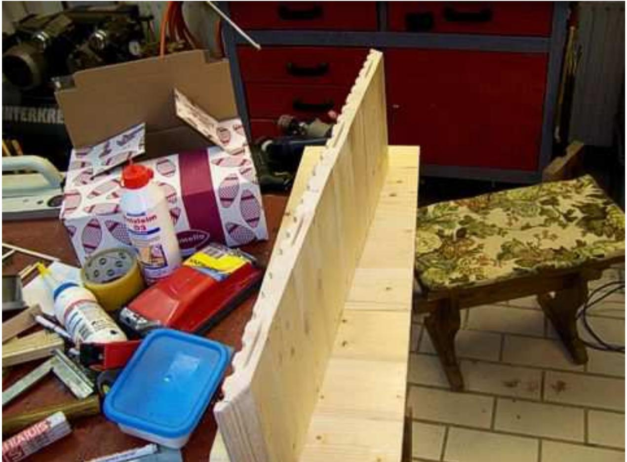
Nach dem einfräsen der Lamello- Schlitze werden die Teile mit den Lamellos verleimt und mit Schraubzwingen fixiert.
