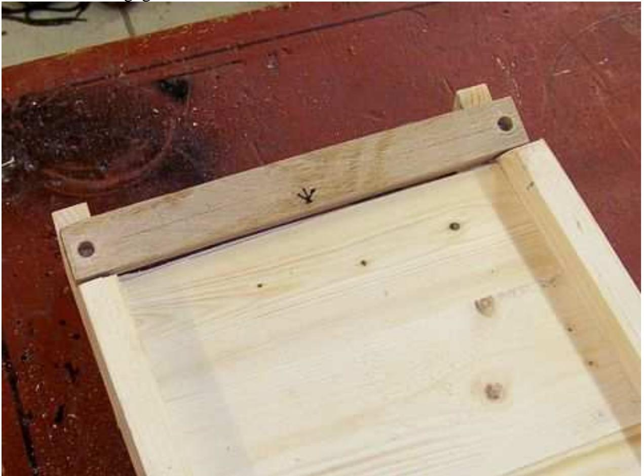
Danach bohre ich die Löcher in den Steg und in das Hausdach. Dann die Holzdübel in den Klettersteg einleimen.
