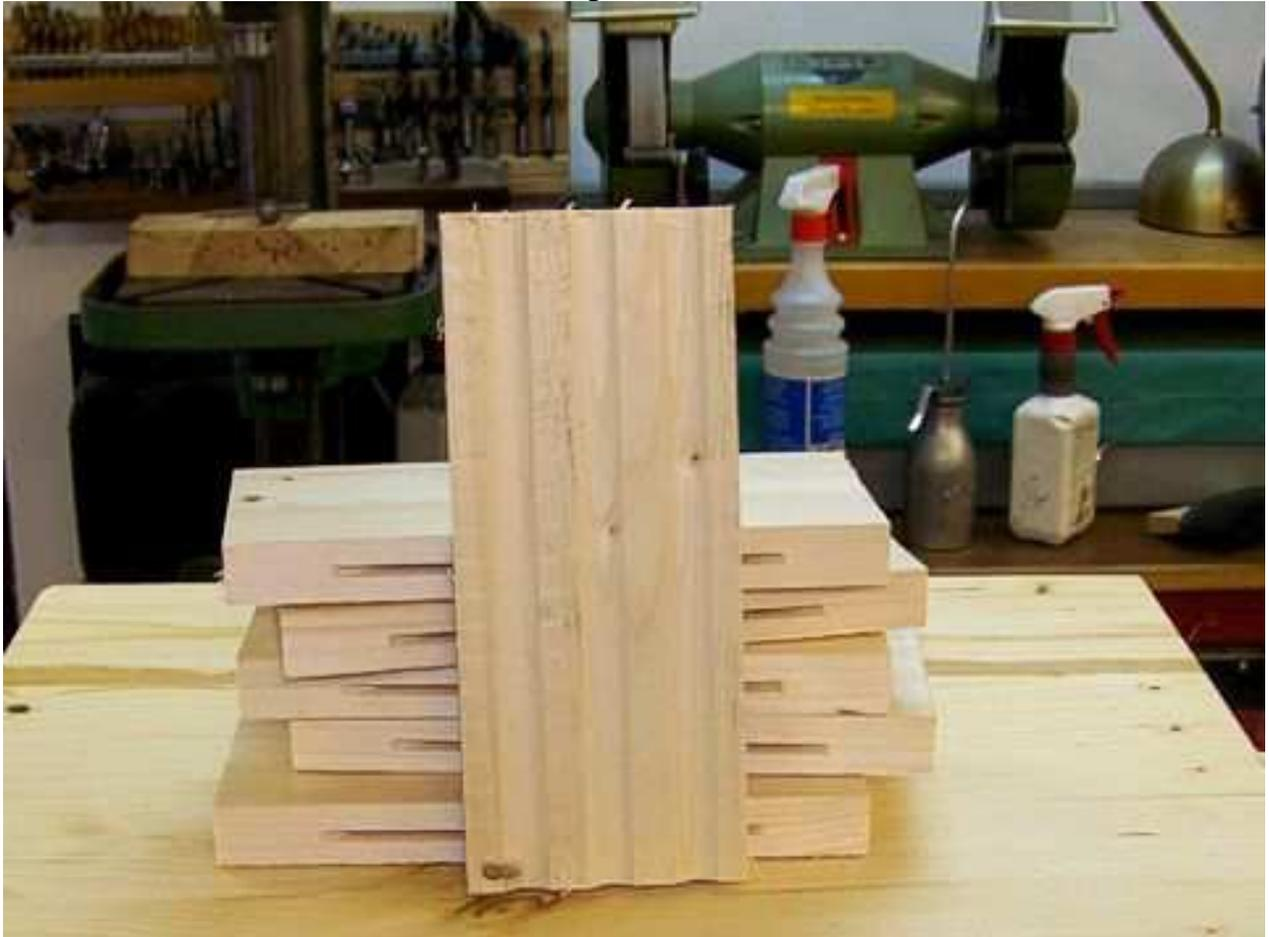
Die Bretter hatten zufällig eine mir passende Unterseite, die später als rutschfeste Lauffläche dienen soll. Man kann auch einfach kleine Holzleisten auf ein glattes Brett leimen. Nach dem einfräsen für die Lamellos, habe ich immer 3 Brettchen zusammengeleimt, und diese am Schluss wieder zu einem Brett verleimt.
