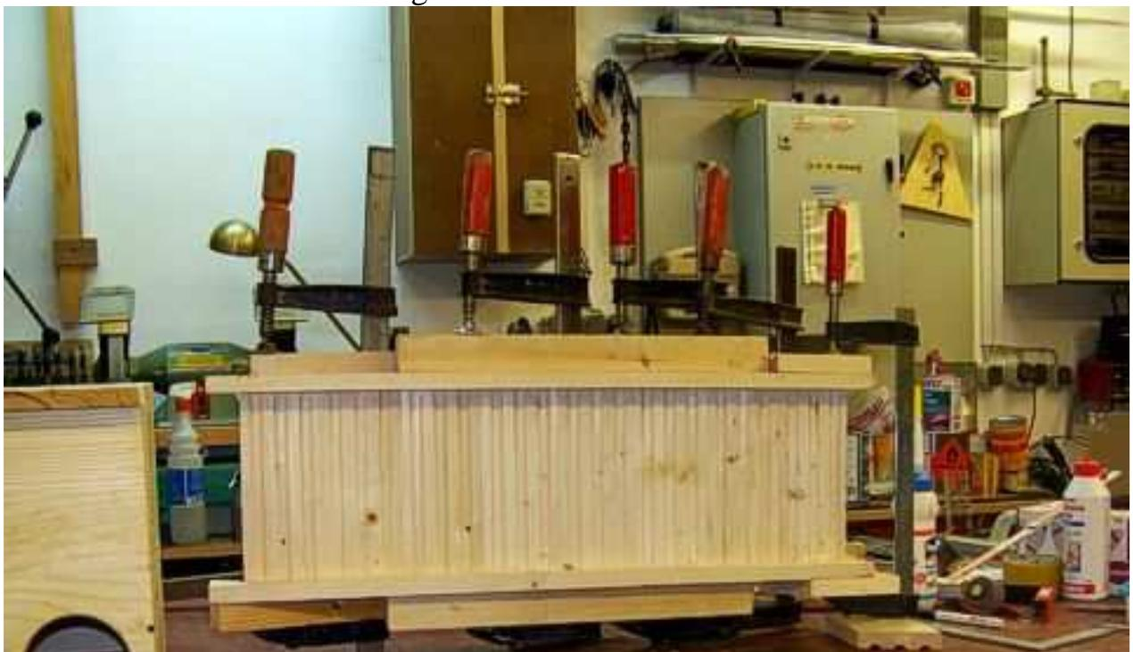
Dann nach aushärten des Leimes, schneid ich mir eine Hartholzleiste in die Länge ab, die genau der Breite des Klettersteges entspricht. Auf dieser Leiste markiere ich die Bohrlöcher für 8mm Holzdübel, die später den Klettersteg sicher am Haus gegen abrutschen halten.
